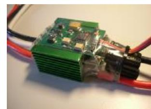
20% Reserven meist beseitigt werden. So kann für das obige Beispiel 2 z.B. ein Schulze future-32.55K (10 LiPo,  $I_{\text{Dauer}} 55\text{A}$ , K = mit Rippenkühlkörper) in einem guten Luftstrom eingesetzt werden.
